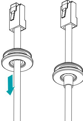
전원 및 오디오와 같은 얇은 케이블 또는 여러 갈래의 케이블을 통과시키는 경우, 완벽한 방수 처리를 위해 별도의 실리콘 마감이 필요합니다. (실리콘 마감 부분-하단 그림 참조)
