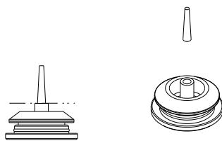
전원 및 오디오와 같은 얇은 케이블 또는 여러 갈래의 케이블을 통과시키는 경우, 완벽한 방수 처리를 위해 별도의 실리콘 마감이 필요합니다. (실리콘 마감 부분-하단 그림 참조)
