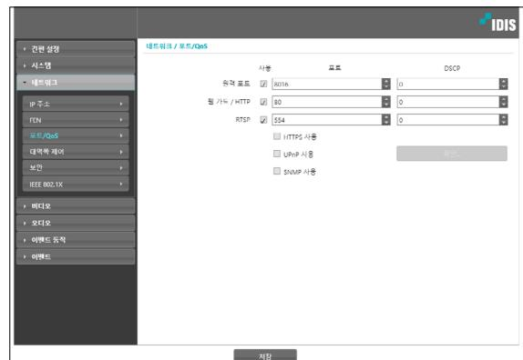
**사용/포트:** 해당 포트의 사용 여부를 선택한 후 포트 번호를 입력합니다. 원격 포트 및 웹 가드/HTTP 포트는 기본적으로 사용하도록 설정되어 있으며 사용 여부를 변경할 수 없습니다. 웹 가드 및 RTSP 포트를 사용하면 웹 가드 프로그램 및 RTSP (Real-Time Streaming Protocol) 서비스를 지원하는 미디어 플레이어를 이용하여 카메라에 접속할 수 있습니다. HTTP 포트를 사용하여 카메라의 원격 설정을 실행할 수 있습니다. 설정 변경 시 저장 버튼을 클릭하여 현재 설정을 모두 적용한 후 원격 설정을 재시작하십시오. 원격 설정을 재시작하지 않는 경우 이후 설정이 적용되지 않습니다.
