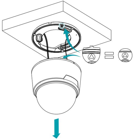
2 설치 마운트에 장착된 안전줄을 카메라 본체의 안전고리에 체결하고, 네트워크 및 전원 어댑터를 연결합니다.
