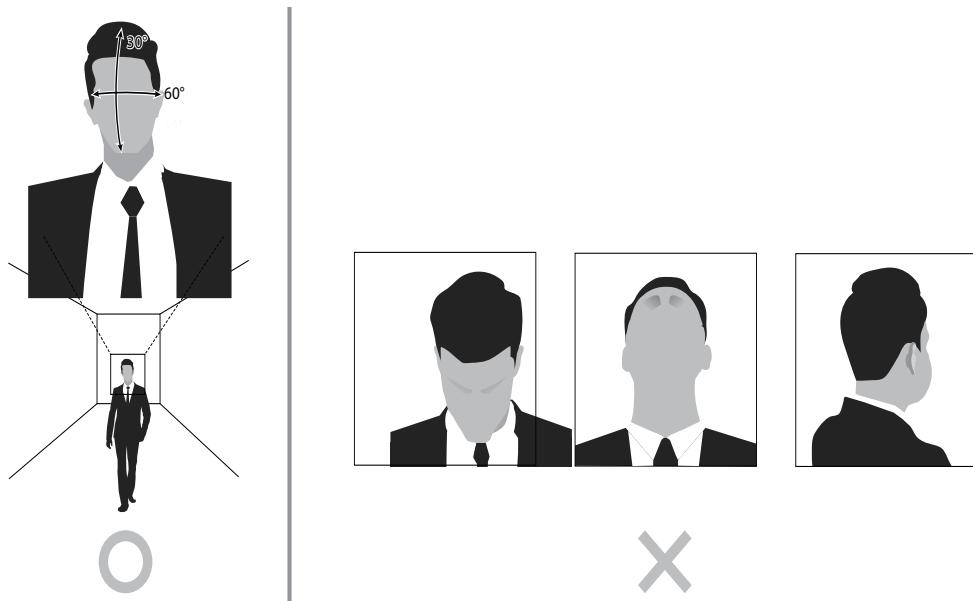
카메라, 특히 물체 감지, 침입, 배회, 라인 크로싱, 얼굴 감지와 같은 AI 기능을 올바르게 작동 및 관리하기 위해서는 아래와 같은 사항이 적용되어야 합니다.
