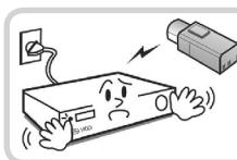
카메라 신규 설치 및 추가 공사 전에 반드시 본 기기의 전원을 차단하고, 제품 구동 중에는 절대로 신호 라인을 연결하지 마세요.
