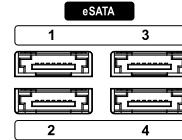
**⚠** NVR의 전원이 켜져 있는 상태에서 eSATA 장비를 연결하거나 제거하지 마세요. eSATA 장비를 연결하는 경우 먼저 NVR을 종료하고 전원케이블을 제거하세요. 그런 후에 eSATA장비와 NVR을 eSATA 케이블로 연결하고 eSATA 장비의 전원을 인가한뒤 NVR의 전원을 켜세요. eSATA 장비를 제거하는 경우 먼저 NVR을 종료하고 전원케이블을 제거한 후, eSATA 장비의 전원을 끄고 eSATA 연결 케이블을 뽑아야 합니다.
