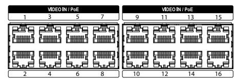
RJ-45 잭을 사용하는 Cat5/Cat5e/Cat6 케이블을 이용하여 네트워크 카메라 또는 비디오 인코더를 연결합니다. 각각의 포트에는 카메라 또는 비디오 인코더 뿐 아니라, 외장 허브 (Option Model : DH-2112PF, DH-2128PF)를 이용해서 망을 구성할 수도 있습니다. DirectIP™ 네트워크 카메라를 사용하면, NVR에서 자동으로 감지합니다. A~P 포트는 PoE를 지원하는 포트입니다.
