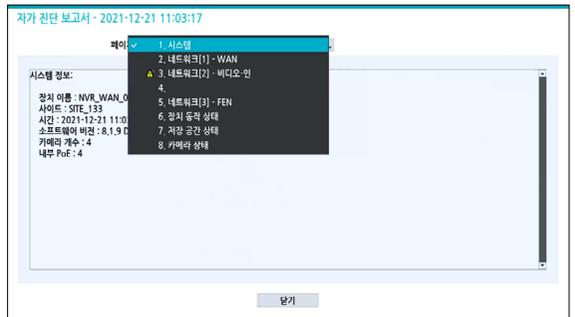
페이지에서 **시스템 / 네트워크 / 장치 동작 상태 / 저장 공간 상태 / 카메라 상태** 등 자가 진단 페이지를 설정 하여 대상 장치의 자가 진단 결과를 확인할 수 있습니다.
