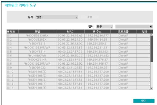
DirectIP 카메라의 경우 자동으로 감지됩니다. IDIS 프로토콜의 경우 자동으로 감지되지 않습니다. 자동 감지가 가능한 DirectIP 프로토콜로 사용하시기를 권장합니다. 프로토콜을 변경하면 NVR에 등록하여 사용될 수 있습니다. 자세한 설정 방법은 해당 네트워크 카메라 사용설명서를 참조하십시오.
