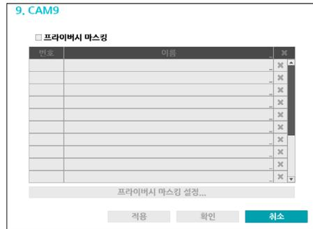
이름을 선택하면 설정된 프라이버시 마스킹 영역의 이름을 변경할 수 있습니다. 설정된 프라이버시 마스킹 영역은 **X** 아이콘을 눌러 개별 삭제하거나 전체 삭제합니다. **프라이버시 마스킹 설정**을 선택하면 영역 설정 화면이 표시됩니다. 마우스로 드래그하여 프라이버시 마스킹 영역을 임의의 크기로 설정 가능하며 최대 16개의 영역을 추가할 수 있습니다.
