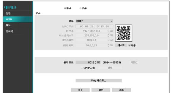
DHCP를 선택하고 저장하면 DHCP 서버로부터 IP 주소 등의 네트워크 정보를 자동으로 받아옵니다. 네트워크 정보를 받아오면 IP 주소 항목에 NVR의 현재 IP 주소가 표시됩니다.
