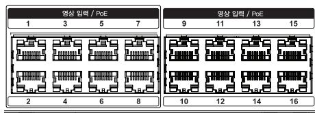
RJ-45 잭을 사용하는 Cat5/Cat5e/Cat6 케이블을 이용하여 네트워크 카메라 또는 비디오 인코더를 연결합니다. 각각의 포트에는 카메라 또는 비디오 인코더 뿐 아니라, 외장 허브 (Option Model : DH-2112PF, DH-2128PF)를 이용해서 망을 구성할 수도 있습니다. DirectIP™ 네트워크 카메라를 사용하면, NVR에서 자동으로 감지합니다.
