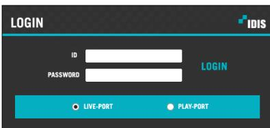
http://www.dvronline.net을 입력하여 접속하는 경우, DEVICE ADDRESS 항목에 NVR의 IP 주소를 입력합니다. 로그인 창에서 Use FEN 서비스 옵션을 선택하면 IP 주소 대신에 FEN 서버에 등록된 NVR 이름을 입력할 수 있으며, SETUP 설정에서 FEN 서버의 주소 및 포트 번호 입력이 요구됩니다.
