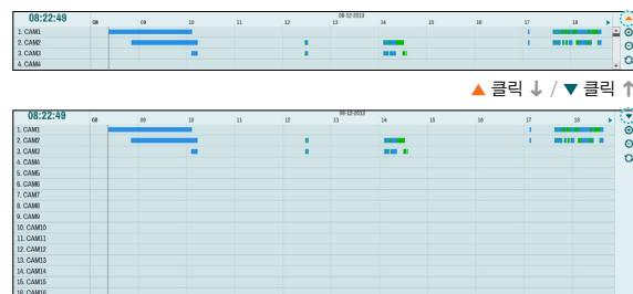
검색창 상단에 녹화된 날짜 및 시간 정보가 표시됩니다. 녹화 테이블의 회색 세로선은 현재 재생 위치를 나타냅니다. 리모컨의 방향 버튼을 이용하여 현재 재생 위치를 구간 단위로 이동할 수 있습니다. 마우스를 이용하여 원하는 재생 위치로 바로 이동할 수 있습니다.
