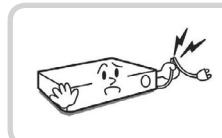
습기 찬 바닥, 접지되지 않은 전원 확장 케이블, 피복이 벗겨진 전원 코드, 안전 접지의 결여 등의 위험한 상황에 노출되지 않도록 주의하세요. 문제가 발생할 경우 구입처나 전문가에게 문의하세요.
