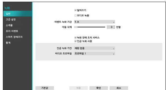
• **덮어쓰기:** 녹화 디스크가 꽉 차게 되면 디스크 단위로 오래된 데이터부터 지워지고 새로운 데이터가 저장됩니다. **덮어쓰기**를 해제하면 녹화 디스크가 꽉 찬을 때 녹화가 중지됩니다.
