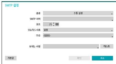
SMTP 서버의 포트 번호 기본값은 25입니다. **테스트**를 선택하면 현재 설정된 값으로 메일이 전송되는지 테스트해볼 수 있습니다. 서버가 지원하는 보안 연결 방식에 따라 SSL/TLS 또는 STARTTLS를 선택하여 사용할 수 있습니다.
