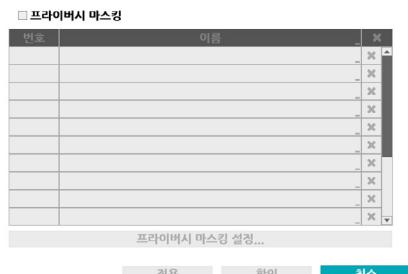
이름을 선택하면 설정된 프라이버시 마스킹 영역의 이름을 변경할 수 있습니다. 설정된 프라이버시 마스킹 영역은  아이콘을 눌러 개별 삭제하거나 전체 삭제합니다. **프라이버시 마스킹 설정**을 선택하면 영역 설정 화면이 표시됩니다. 마우스로 드래그하여 프라이버시 마스킹 영역을 임의의 크기로 설정 가능하며 최대 16개의 영역을 추가할 수 있습니다.
