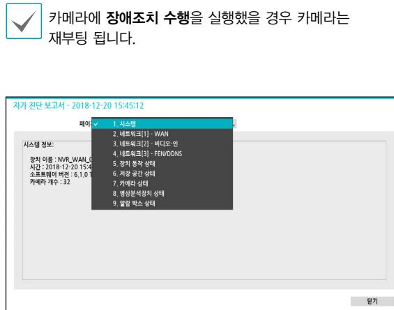
페이지에서 시스템 / 네트워크 / 장치 동작 상태 / 저장 공간 상태 / 카메라 상태 / 영상분석장치 상태 등 자가 진단 페이지를 설정하여 대상 장치의 자가 진단 결과를 확인할 수 있습니다.
