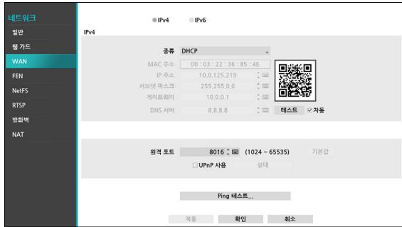
DHCP를 선택하고 저장하면 DHCP 서버로부터 IP 주소 등의 네트워크 정보를 자동으로 받아옵니다. 네트워크 정보를 받아오면 IP 주소 항목에 NVR의 현재 IP 주소가 표시됩니다.
