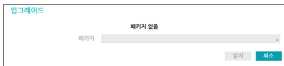
• **온라인 펌웨어 업그레이드 도구:** 원격지 서버에 접속하여 업그레이드를 진행합니다. 온라인 펌웨어 업그레이드 도구를 눌러 업그레이드 패키지 파일을 선택한 후, 설치 버튼을 선택하여 시스템을 업그레이드를 할 수 있습니다. 업그레이드 후에 자동으로 NVR이 재부팅됩니다.
