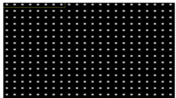
영역 설정 화면에서 리모컨의 방향 버튼을 이용하여 블럭 단위의 영역 선택창을 상하좌우로 이동할 수 있습니다. 선택창은 8개 블럭 크기의 한 줄에 해당하며 **카메라 버튼**으로 각 블럭을 선택/해제시킬 수 있습니다. 마우스를 이용하여 원하는 영역을 드래그 한 후 선택/해제/반전 시킬 수도 있습니다.
