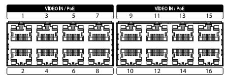
RJ-45 잭을 사용하는 Cat5/Cat5e/Cat6 케이블을 이용하여 네트워크 카메라 또는 비디오 인코더를 연결합니다. 각각의 포트에는 카메라 또는 비디오 인코더 뿐 아니라, 외장 허브 (Option Model : DH-2112PF, DH-2128PF)를 이용해서 망을 구성할 수도 있습니다. DirectIP™ 네트워크 카메라를 사용하면, NVR에서 자동으로 감지합니다. A~P 포트는 PoE를 지원하는 포트입니다.
