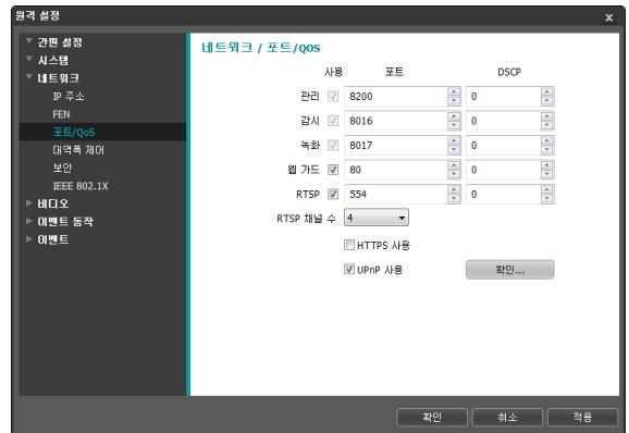
**사용/포트:** 해당 포트의 사용 여부를 선택한 후 포트 번호를 입력합니다. 관리, 감시 및 녹화 포트는 기본적으로 사용하도록 설정되어 있으며 사용 여부를 변경할 수 없습니다. 웹 가드 및 RTSP 포트를 사용하면 웹 가드 프로그램 및 RTSP (Real-Time Streaming Protocol) 서비스를 지원하는 미디어 플레이어를 이용하여 카메라에 접속할 수 있습니다. 설정 변경 시 현재 설정을 모두 적용한 후 원격 설정이 종료됩니다. (관리 포트 번호만 해당)
