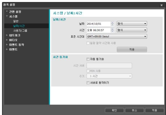
• **날짜/시간:** 카메라의 날짜/시간 및 날짜/시간 표기 방식을 변경할 수 있으며, 표준 시간대 및 일광 절약 시간제를 설정할 수 있습니다. **적용** 버튼을 클릭하면 변경 사항을 바로 적용합니다.
