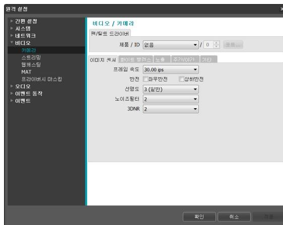
**팬/틸트 드라이버:** 탭을 선택하여 팬/틸트 드라이버를 설정합니다. 장착된 팬/틸트 드라이버 모델을 선택한 후 ID를 설정합니다. **포트** 버튼을 클릭하여 팬/틸트 드라이버 제조사의 지시에 따라 포트 속도, 데이터 비트, 정지 비트, 패리티 값을 설정합니다.
