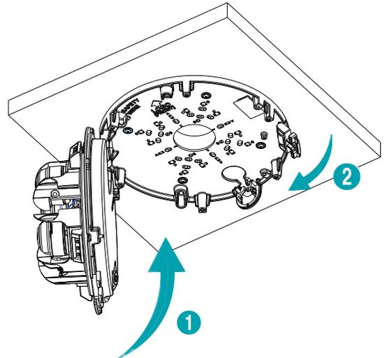
8 구성품으로 제공된 L렌치를 이용하여 카메라 본체의 체결용 나사를 시계 방향으로 돌려 카메라 본체를 설치 브라켓에 고정시킵니다.
