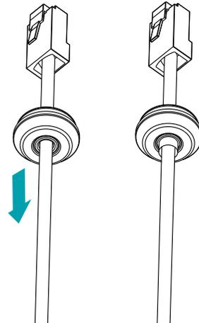
전원 및 오디오와 같은 얇은 케이블 또는 여러 갈래의 케이블을 통과시키는 경우, 완벽한 방수 처리를 위해 별도의 실리콘 마감이 필요합니다. (실리콘 마감 부분-하단 그림 참조)
