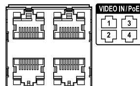
RJ-45 잭을 사용하는 Cat5/Cat5e/Cat6 케이블을 이용하여 네트워크 카메라 또는 비디오 인코더를 연결합니다. DirectIP™ 네트워크 카메라를 사용하면, NVR에서 자동으로 감지합니다.
