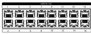
RJ-45 잭을 사용하는 Cat5/Cat5e/Cat6 케이블을 이용하여 네트워크 카메라 또는 비디오 인코더를 연결합니다. DirectIP™ 네트워크 카메라를 사용하면, NVR에서 자동으로 감지합니다.
