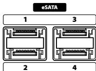
**⚠** NVR의 전원이 켜져 있는 상태에서 eSATA 장비를 연결하거나 제거하지 마세요. eSATA 장비를 연결하는 경우 먼저 NVR을 종료하고 전원케이블을 제거하세요. 그런 후에 eSATA장비와 NVR을 eSATA 케이블로 연결하고 eSATA 장비의 전원을 인가한뒤 NVR의 전원을 켜세요. eSATA 장비를 제거하는 경우 먼저 NVR을 종료하고 전원케이블을 제거한 후, eSATA 장비의 전원을 끄고 eSATA 연결 케이블을 뽑아야 합니다.
