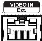
RJ-45 잭을 사용하는 Cat5/Cat5e/Cat6 케이블을 이용하여 네트워크 카메라 또는 비디오 인코더 뿐 아니라, 외장 허브 (Option Model : DH-2112PF, DH-2128PF, DH-2212PF) 를 이용해서 망을 구성할 수도 있습니다. DirectIP 네트워크 카메라를 사용하면 NVR에서 자동으로 감지합니다.
