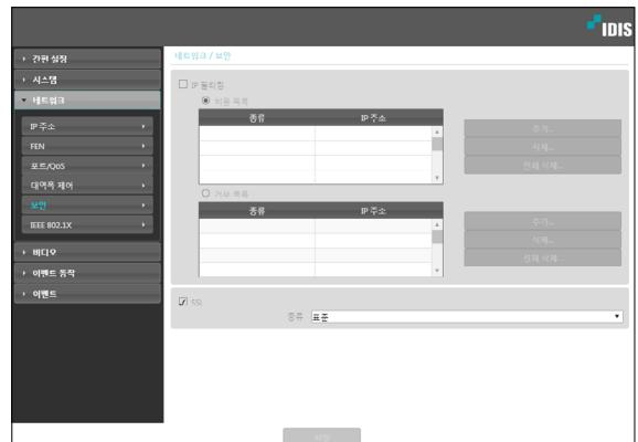
• **IP 필터링:** 항목을 선택하여 IP 필터링 기능을 사용할 수 있습니다. IP 필터링 기능을 사용하면 특정 IP 주소에 대해 해당 카메라로의 접속을 허용하거나 차단하도록 설정할 수 있습니다.
