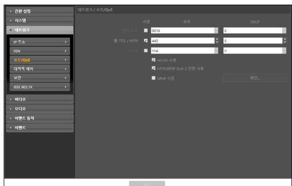
**• 사용/포트:** 해당 포트의 사용 여부를 선택한 후 포트 번호를 입력합니다. 원격 포트 및 웹 가드/HTTP 포트는 기본적으로 사용하도록 설정되어 있으며 사용 여부를 변경할 수 없습니다. 웹 가드 및 RTSP 포트를 사용하면 웹 가드 프로그램 및 RTSP (Real-Time Streaming Protocol) 서비스를 지원하는 미디어 플레이어를 이용하여 카메라에 접속할 수 있습니다. HTTP 포트를 사용하여 카메라의 원격 설정을 실행할 수 있습니다. 설정 변경 시 저장 버튼을 클릭하여 현재 설정을 모두 적용한 후 원격 설정을 재시작하십시오. 원격 설정을 재시작하지 않는 경우 이후 설정이 적용되지 않습니다.
