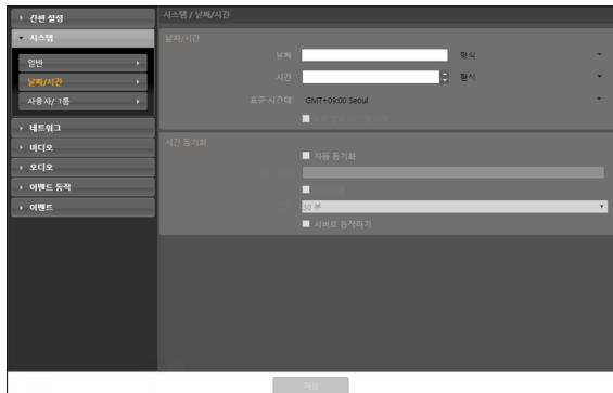
• **날짜/시간:** 카메라의 날짜/시간 및 날짜/시간 표기 방식을 변경할 수 있으며, 표준 시간대 및 일광 절약 시간제를 설정할 수 있습니다. 저장 버튼을 클릭하면 변경 사항을 바로 적용합니다.
