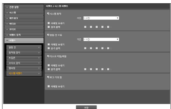
**시스템 이벤트** 항목을 선택하여 시스템 이벤트를 설정합니다. 시스템 이벤트를 설정하면 시스템 상태 및 알람 인 상태, 디스크 삽입 여부, 로그를 주기적으로 확인하여 통보합니다.
