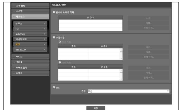
• **IP 필터링:** 항목을 선택하여 IP 필터링 기능을 사용할 수 있습니다. IP 필터링 기능을 사용하면 특정 IP 주소에 대해 해당 카메라로의 접속을 허용하거나 차단하도록 설정할 수 있습니다.
