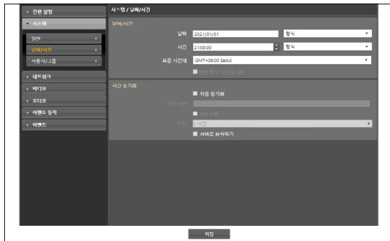
• **날짜/시간:** 카메라의 날짜/시간 및 날짜/시간 표기 방식을 변경할 수 있으며, 표준 시간대 및 일광 절약 시간제를 설정할 수 있습니다. **저장** 버튼을 클릭하면 변경 사항을 바로 적용합니다.
