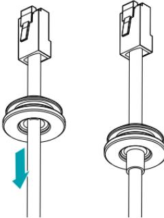
전원 및 오디오와 같은 얇은 케이블 또는 여러 갈래의 케이블을 통과시키는 경우, 완벽한 방수 처리를 위해 별도의 실리콘 마감이 필요합니다. (실리콘 마감 부분- 하단 그림 참조)
