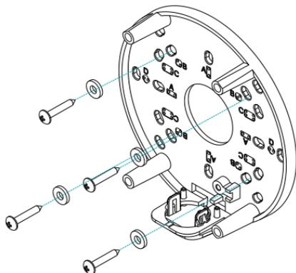
2 사전에 준비한 LAN 케이블의 고무와 IO 케이블에 삽입된 고무를 설치 플레이트에 통과시킨 뒤, 정션 박스에 조립합니다.
