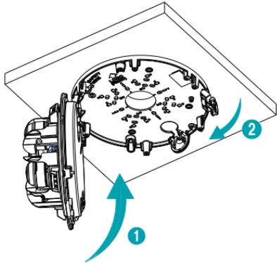
9 구성품으로 제공된 L렌치를 이용하여 카메라 본체의 체결용 나사를 시계 방향으로 돌려 카메라 본체를 설치 브라켓에 고정시킵니다.
