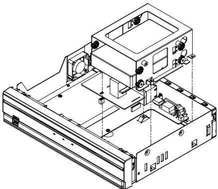
7 HDD가 장착된 브라켓을 본체에 다시 장착하고, HDD 브라켓을 고정하는 나사 6개를 조여 고정시키세요.
