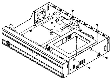
6 HDD 브라켓 좌/우측 4개의 나사를 풀어 HDD를 브라켓과 분리하세요. 새로운 HDD를 장착하고 HDD 고정나사를 조여 고정시키세요. 이 때 장착하는 방향에 주의하세요.
