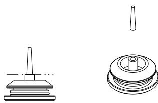
전원 및 오디오와 같은 얇은 케이블 또는 여러 갈래의 케이블을 통과시키는 경우, 완벽한 방수 처리를 위해 별도의 실리콘 마감이 필요합니다. (실리콘 마감 부분-하단 그림 참조)
