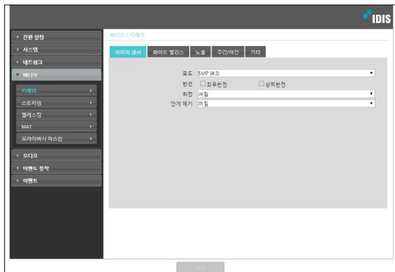
• **회전:** 방향을 선택하여 영상을 시계 방향 또는 반시계 방향으로 90° 회전시킵니다. 단, 수직 해상도가 320° 보다 작은 경우 본 기능이 지원되지 않습니다. 본 기능을 사용하면 복도나 통로 등 길고 좁은 공간을 감시할 때 보다 효과적으로 감시할 수 있습니다. 반전 기능과 회전 기능을 모두 사용하는 경우 반전 기능이 먼저 적용되고 난 후에 회전 기능이 적용됩니다.
