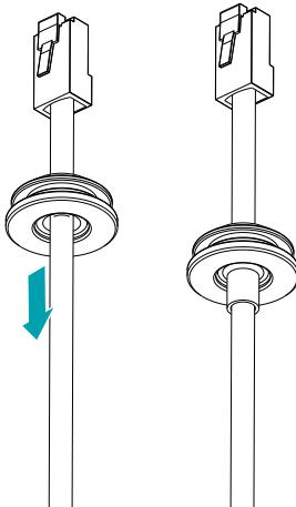
전원 및 오디오와 같은 얇은 케이블 또는 여러 갈래의 케이블을 통과시키는 경우, 완벽한 방수 처리를 위해 별도의 실리콘 마감이 필요합니다. (실리콘 마감 부분-하단 그림 참조)
