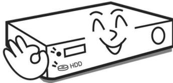
데이터를 저장하는 HDD가 수명이 다하면 저장하려는 영상 데이터가 손상되어 복구되지 않을 수 있습니다. 녹화 중에 HDD에 저장되어 있는 데이터를 재생할 경우 화면이 깨지면 HDD의 수명이 다한 것이므로 빨리 구입처나 서비스 센터에 의뢰하여 HDD를 교체하시기 바랍니다.
